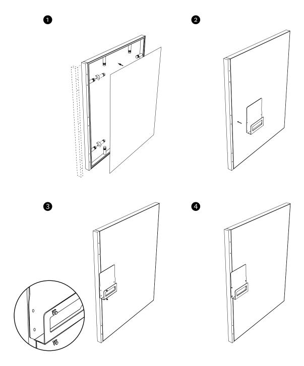
Schrauben Sie das Abschlussprofil mittels Verbinder an. Bringen Sie die Paneele an.
