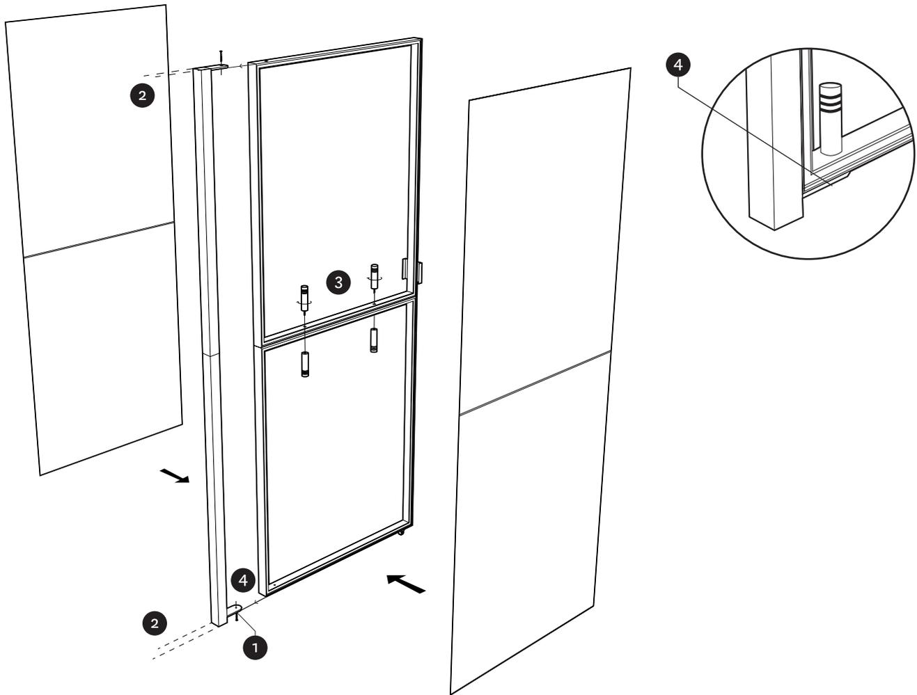
1. Bringen Sie die Schraube am Henkel des unteren Eckprofiles an.
